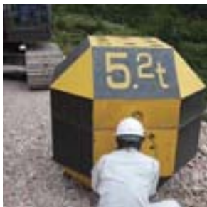
● 重錘 (質量 5.2t、直径 1.408m) ※ 重錘は EOTA (European Organisation for Technical Approvals) の実験重錘規格に準拠
