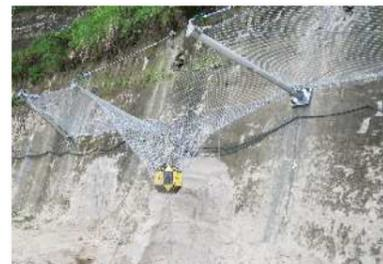
鉛直落下式による実規模実証実験
