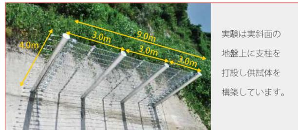
実験は実斜面の地盤上に支柱を打設し供試体を構築しています。
