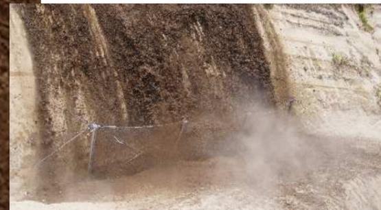
土砂流下式による実規模実証実験
