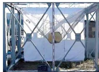
落石衝撃荷重実験
