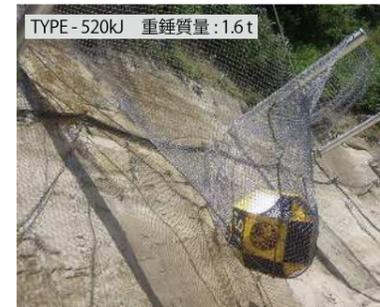
実験の結果、全タイプにおいて、阻止面から抜け出すことなく重錘を捕捉し、適用可能エネルギー以上の防護性能と落石防護柵の機能について確認することができました。
