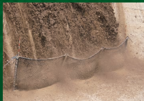
● 実規模実証実験 (崩壊土砂衝突実験)
