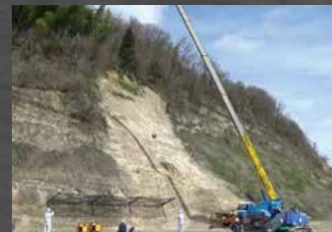
● 実規模実証実験（鉛直落下式）
