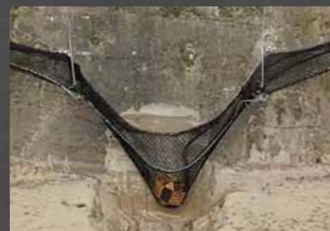
● 実規模実証実験（重錘落下エネルギー E=312.5kJ）
