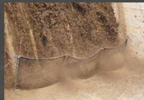
● 実規模実証実験（崩壊土砂衝突実験）
